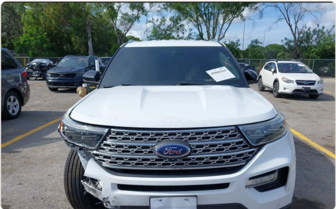
4. Vista frontal. Capó y faros en línea: el golpe fue de esquina, no frontal completo. Consistente con "encendía y rodaba".
