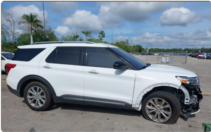
3. Lateral derecho. Llanta delantera derecha desinflada; el rin pudo recibir parte del golpe. Revisar por fisuras.
