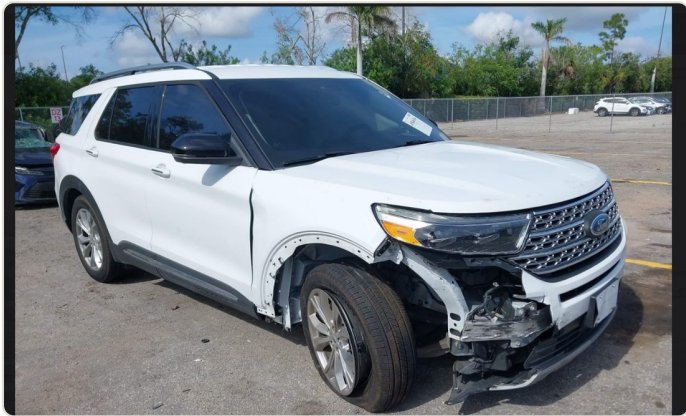
1. Impacto frontal derecho. Bumper desprendido, tapabarro dañado, componentes colgando. Aquí viven el radiador, el condensador y el intercooler.
