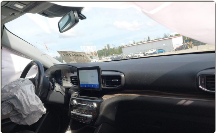
2. Bolsas de aire activadas. Bolsa del conductor colgando del volante y cortina lateral desplegada. Verificar reemplazo real es el punto N.º 1 de la inspección.
